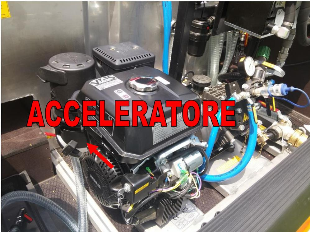
4. La motopompa è pronta per erogare acqua. Quindi è necessario aprire le mandate (posizionando le leve in modo verticale) per immettere acqua nei naspi e, successivamente, dare pressione alzando la leva di fianco al manometro.
